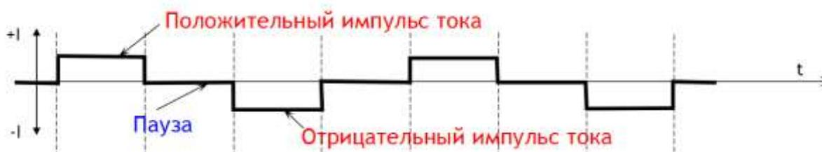
Рисунок 1. Форма тока, пропускаемого через заземлённую электрическую линию
