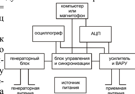
Рисунок 31. Блок-схема георадара «Зонд-10»
