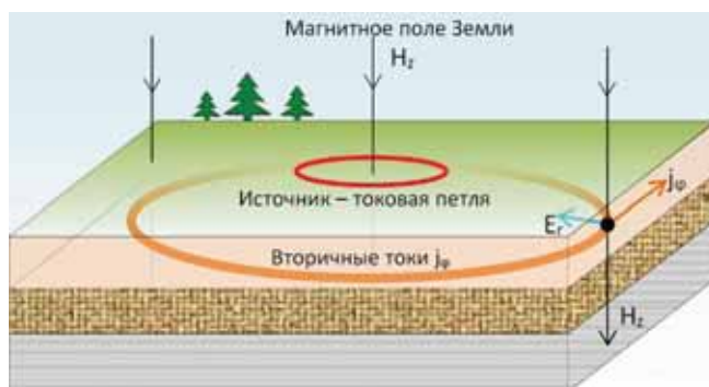
Рис. 1. Появление холловской напряженности электрического поля
