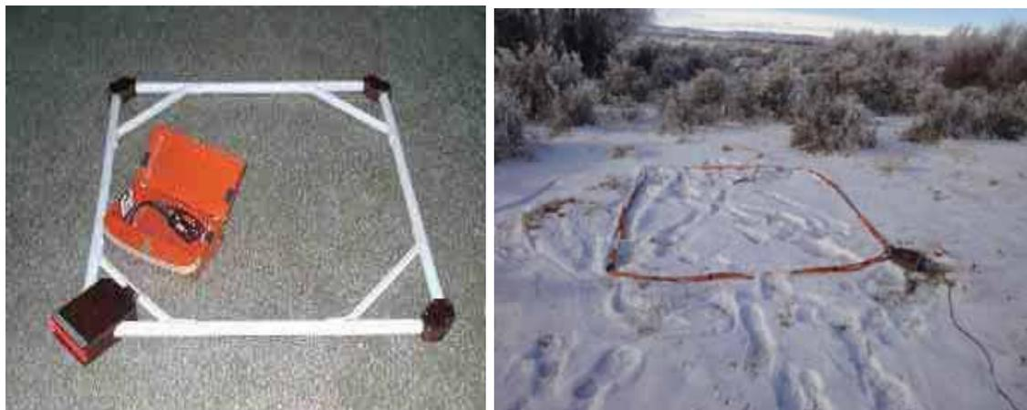
Рис. 4.15. Приемные индукционные (импульсные) датчики «ПДИ»
