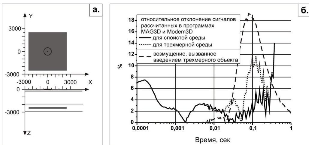
Рисунок 3 (а) Модель №3 и схема установки; (б) относительное отклонение сигналов рассчитанных в программах MAG3D и Modem3D для модели №3
