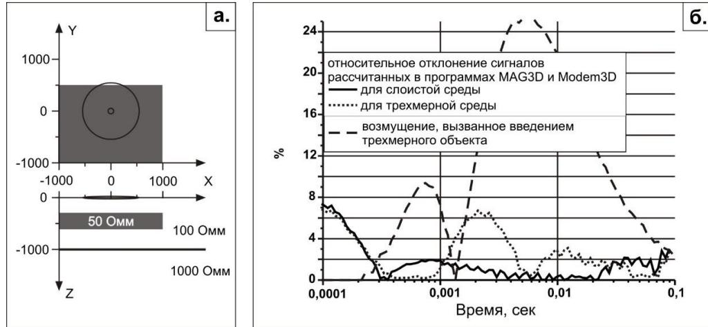
Рисунок 1 (а) Модель №1 и схема установки; (б) относительное отклонение сигналов рассчитанных в программах MAG3D и Modem3D для модели №1
