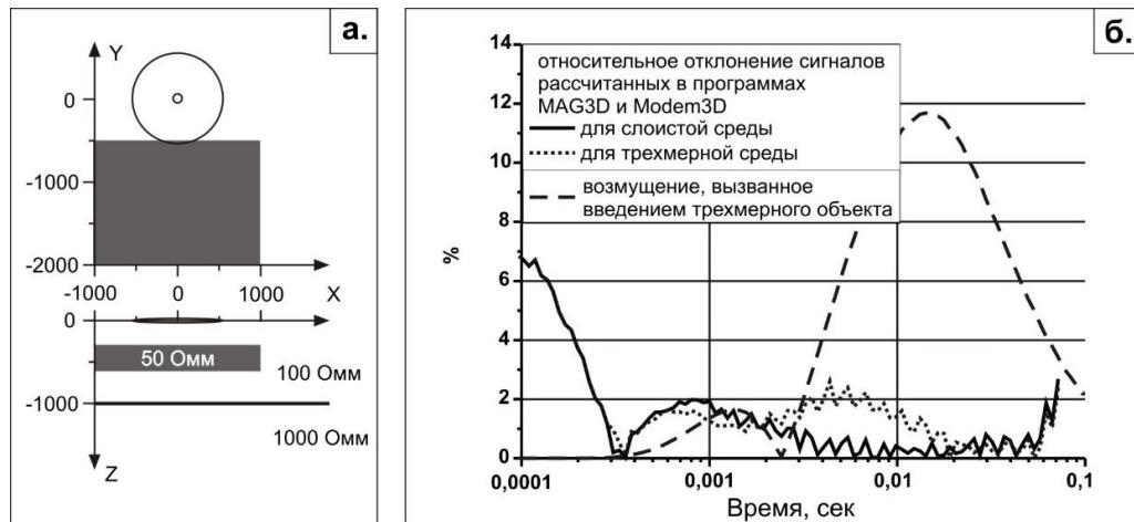
Рисунок 2 (а) Модель №2 и схема установки; (б) относительное отклонение сигналов рассчитанных в программах MAG3D и Modem3D для модели №2
