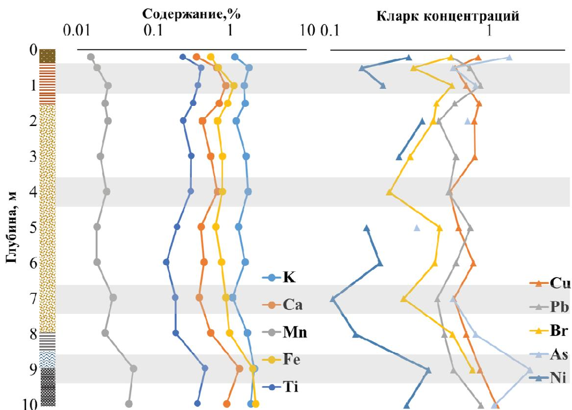
Рис. 5. Изменение концентраций элементов по глубине керна
